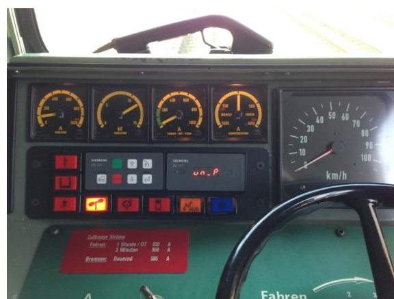
Figura 11: Esempio di montaggio del apparecchio di comando e d'indicazione
