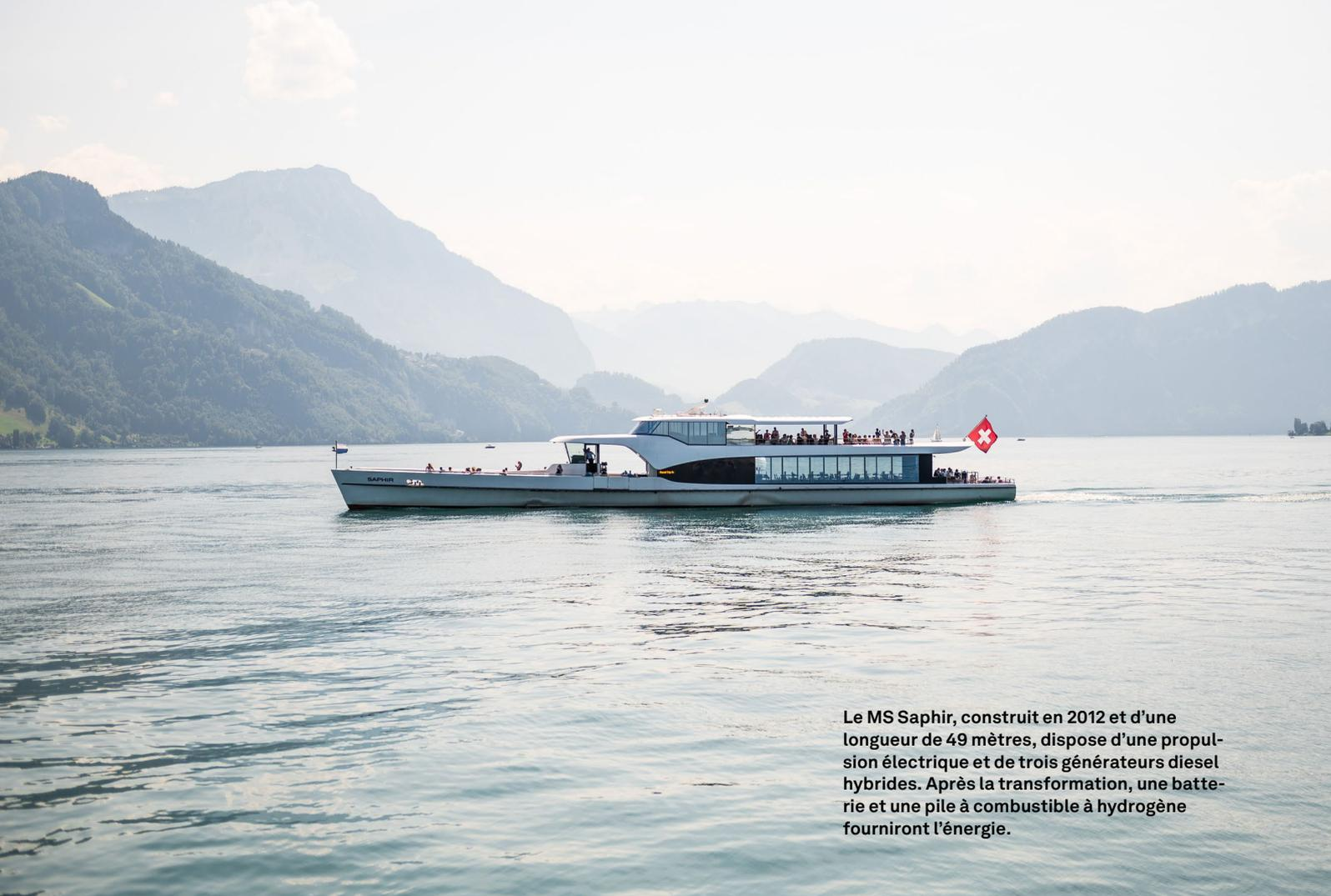
**Le MS Saphir, construit en 2012 et d'une longueur de 49 mètres, dispose d'une propulsion électrique et de trois générateurs diesel hybrides. Après la transformation, une batterie et une pile à combustible à hydrogène fourniront l'énergie.**
