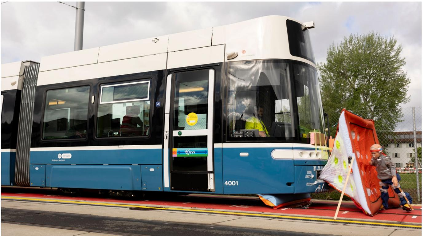
**Déclenchement expérimental de l'airbag frontal. Un deuxième airbag, également visible, sert à éviter qu'une personne passe sous le tram.**
