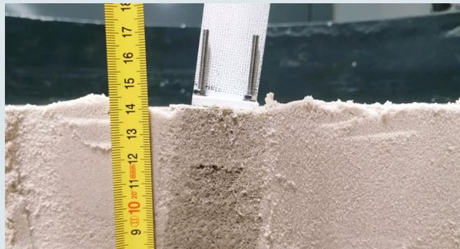
Les mâts de la ligne de contact, les parois antibruit et autres éléments d'infrastructure doivent être solidement ancrés dans le sol. Les blocs de fondation en béton sont coulés sur place aux dimensions standard. Dans les sols mous ou dans les talus, leurs dimensions doivent être majorées. Mais de combien ?
