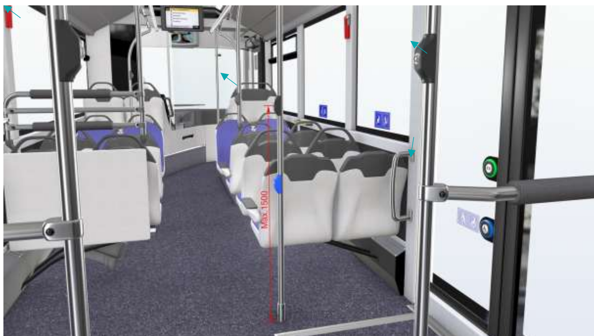
Figura 2: pulsante per l'apertura della porta (dimensionamento)
