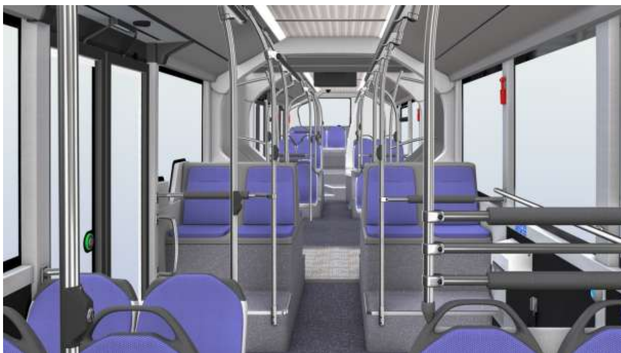
Figura 3: esempio di disposizione dei corrimano
