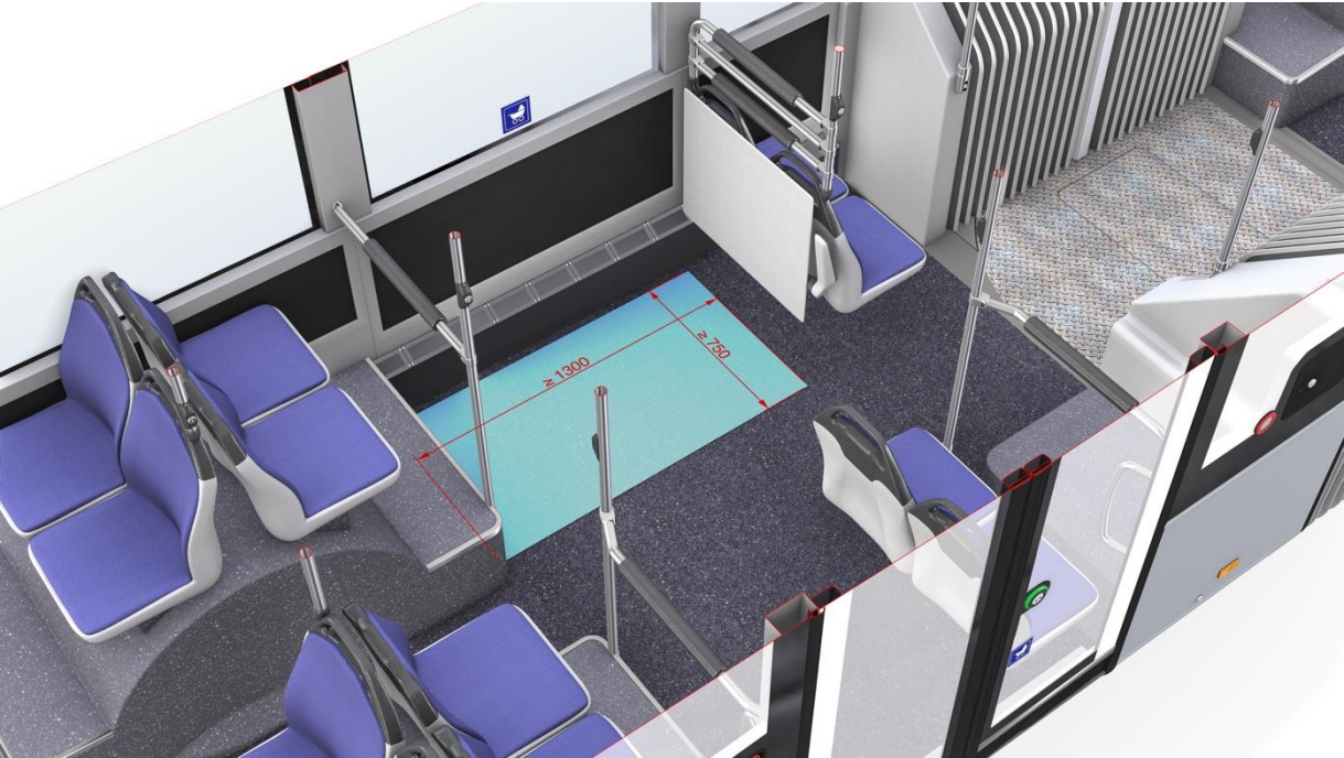
Figura 17: dimensionamento del posto per passeggini (vista nel senso di marcia)
