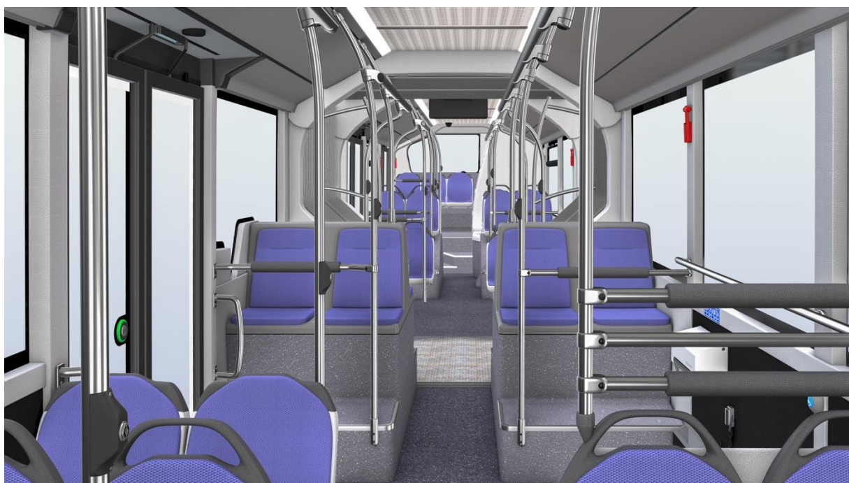
Figura 3: esempio di disposizione dei corrimano
