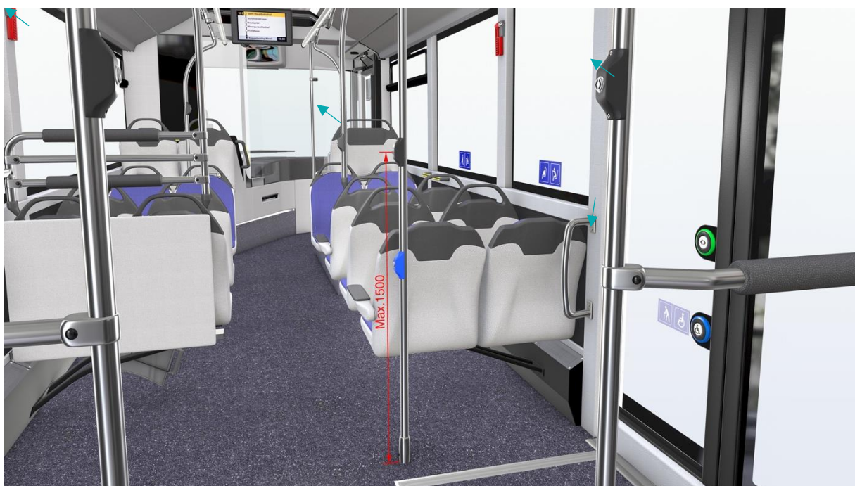
Figura 2: pulsante per l'apertura della porta (dimensionamento)
