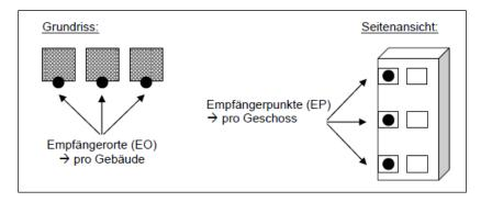
Fig. 4: Punti di ricezione sugli edifici (pianta e vista laterale)
