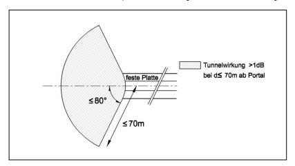
Fig. 3: Portale di galleria senza assorbimento e con **piattabanda fissa**: rilevanza per punti di immissione, la cui linea di visuale sul portale forma un angolo ≤ 80° con l'asse della galleria e presenta una distanza ≤ 70 m.
