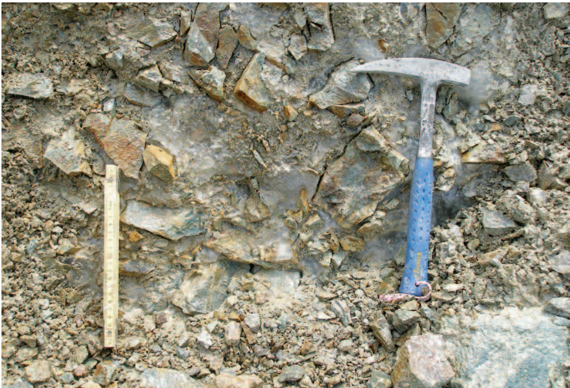
Fig. 34: Matériau meuble riche en glace dans une fente de sondage.
