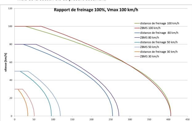
Les courbes « ZBMS » indiquent la distance de freinage calculée au moyen de la formule de la section 3.5 du présent document.
