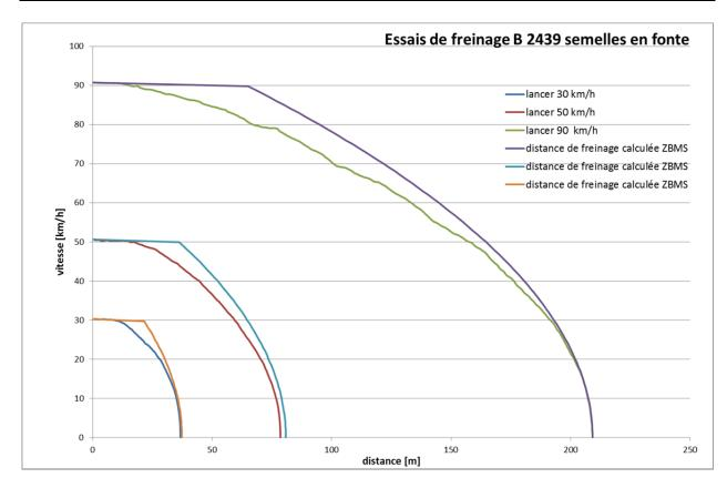
Le wagon D 4209 équipé d'un frein à vide simple et de semelles de frein en fonte Samson (GG P30) a été lancé à sa vitesse maximale de 90 km/h ainsi qu'à 50 km/h. Les paramètres calculés révèlent un temps de réaction de 2,8 s et une décélération de 1,39 m/s². Les essais ont eu lieu sur un tronçon plat.
