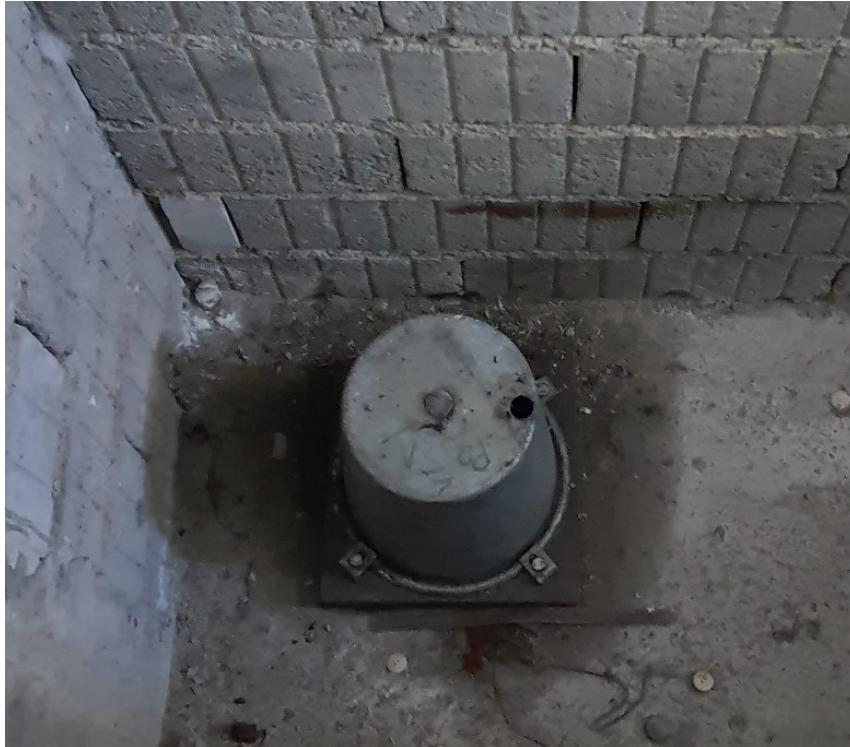
**Typ Messanker:** Anker, der mit einer Kraftmesseinrichtung ausgerüstet ist, sodass jederzeit eine Messung der Spannkraft möglich ist. (Hinweis **mit** Verkabelung)
