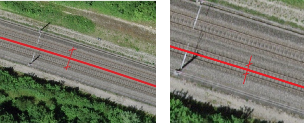
Abb. 1 Fiktive Beispiele zur Erfassungsgenauigkeit von Strecken- (links) und Gleisachsen (rechts)
