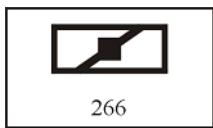
Bedeutung Ende Gleisschlaufe für Impulsempfänger
