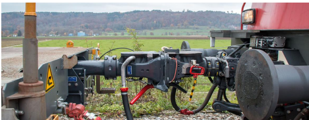
Figura 8: Accoppiamento Scharfenberg con condotta del freno integrata (fonte: FFS Cargo)
