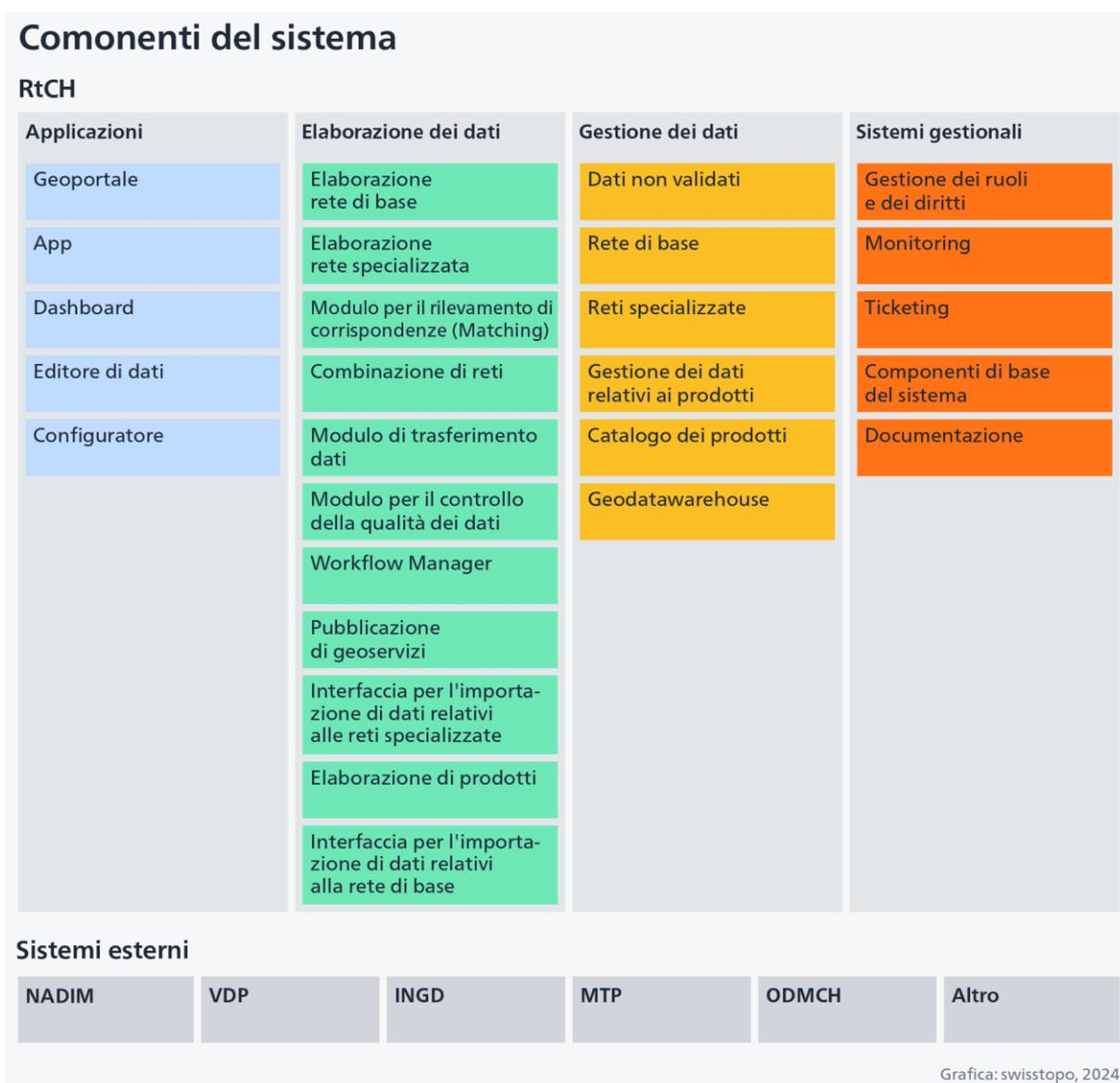
Figura 6: panoramica delle componenti del sistema Rete dei trasporti CH.
