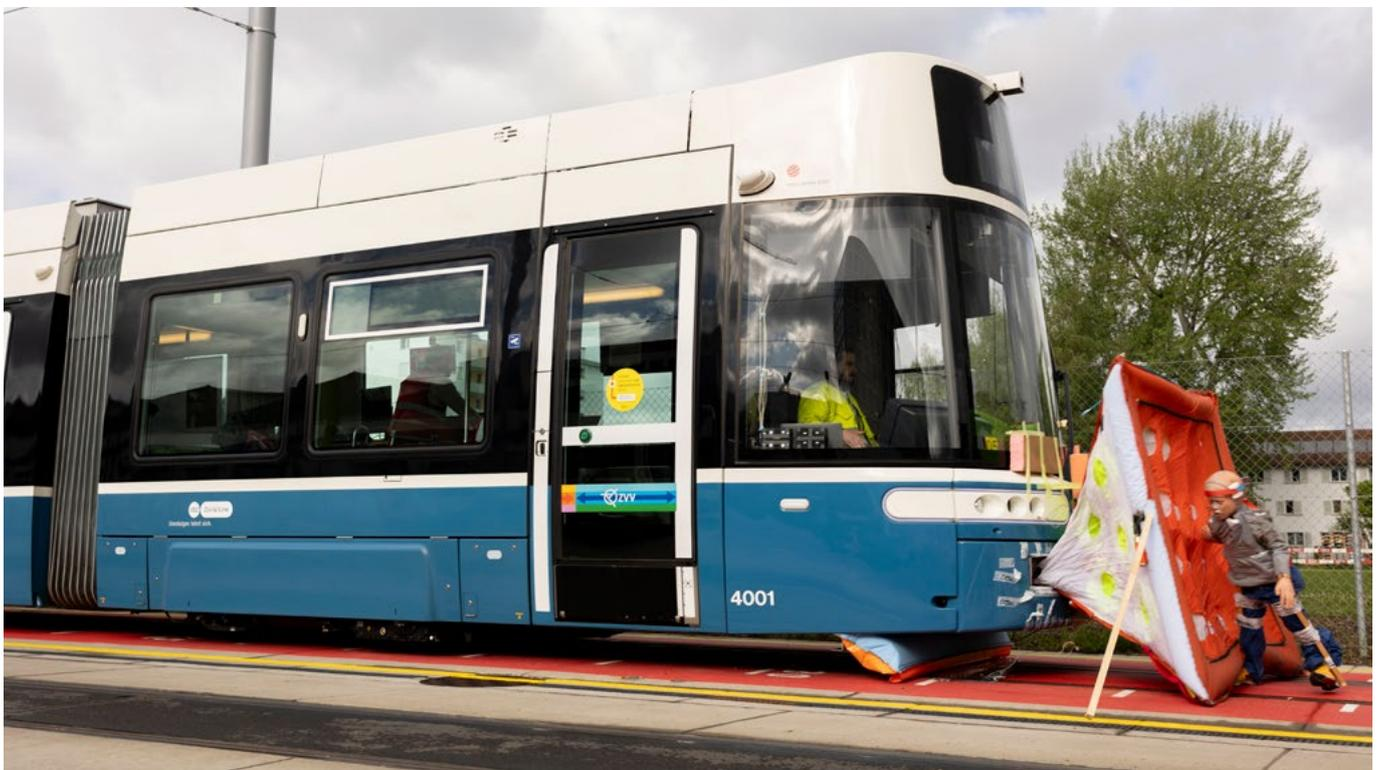
**Déclenchement expérimental de l'airbag frontal.**
