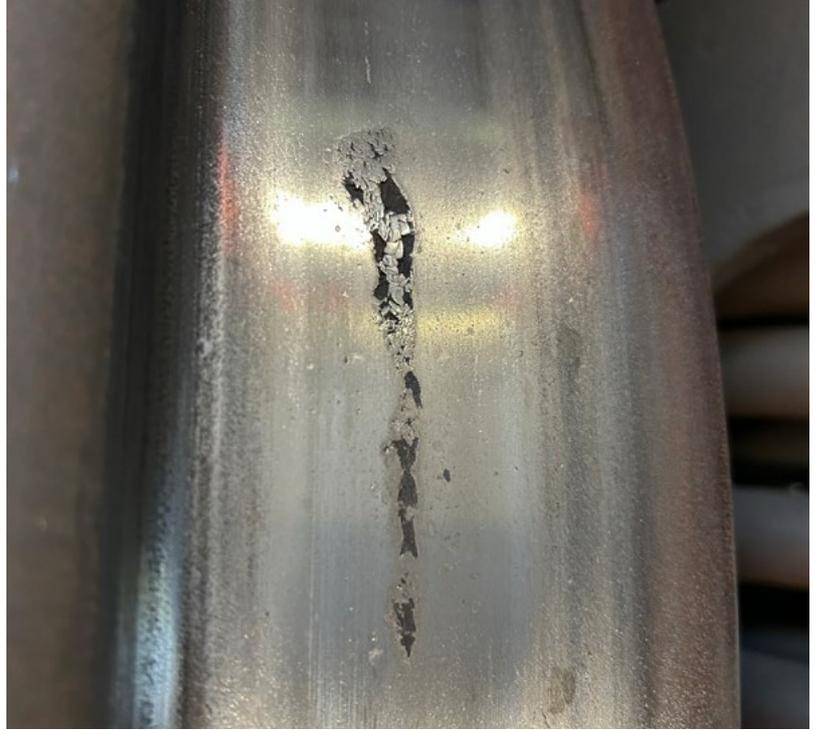
**Dégâts sur la surface de roulement de la roue.**
