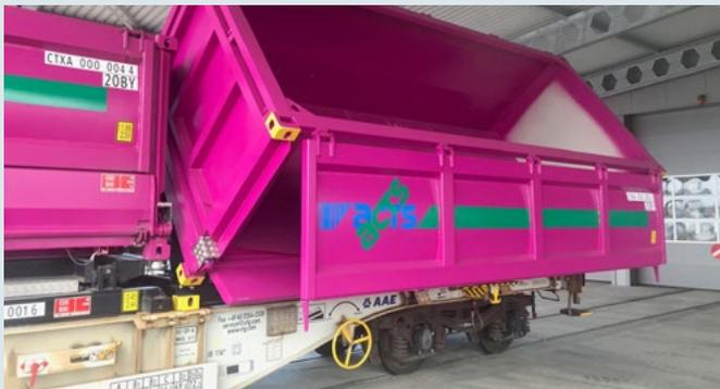
De nombreux grands chantiers ne peuvent pas être desservis directement par le rail. Les déblais ou les débris d'excavation doivent alors être transportés par camion jusqu'au raccordement ferroviaire le plus proche, où ils sont transbordés sur des wagons. Cette opération fastidieuse peut désormais être simplifiée grâce à un conteneur basculant.
