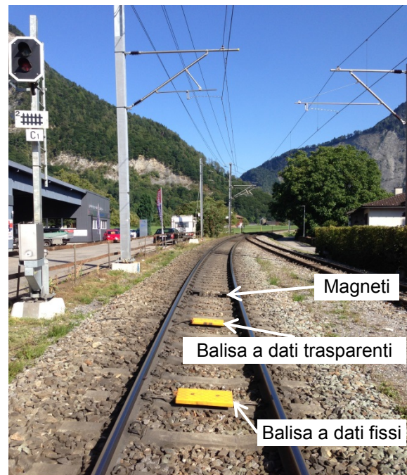
Figura 2: Posizionamento con mantenimento dei magneti
