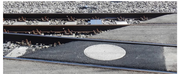
Figura 10: Balise incassata nel corpo stradale
