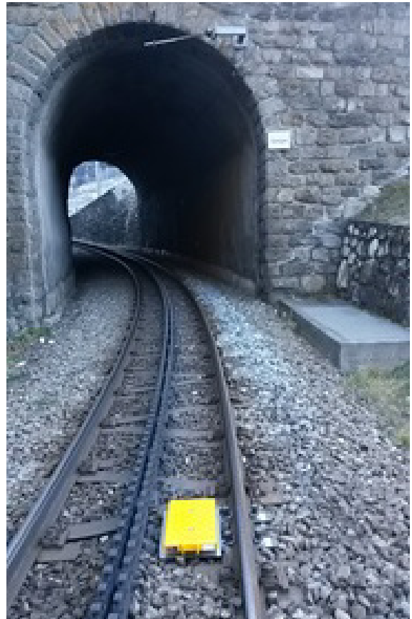
Figura 4: Esempio di montaggio su tratto a cremagliera
