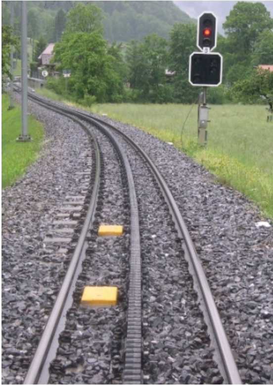
Figura 11 Eurobalise di un punto di controllo nel settore a cremagliera
