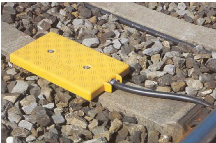
Figura 10 Balise per dati trasparenti sul binario
