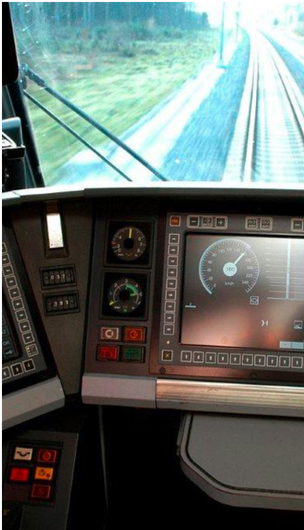
Dati del sistema ETCS L2 sullo schermo del macchinista.
