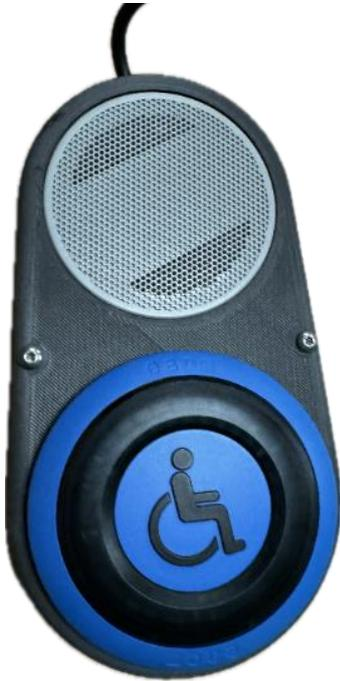
Abbildung 5.7: Lautsprecher und Türtaster der präparierten Versuchstür
