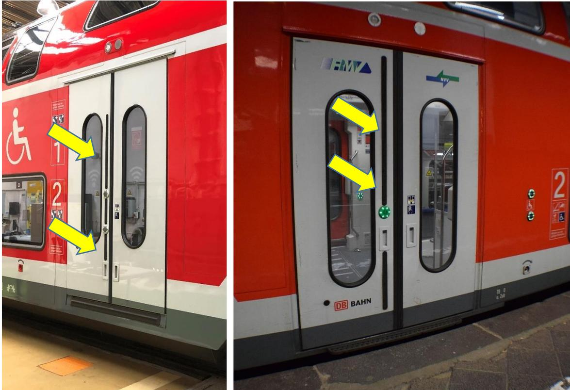
Abbildung 6.1 a-b: Ansicht einer Zugtür mit taktiler Hilfe (Blindentaststreifen)
