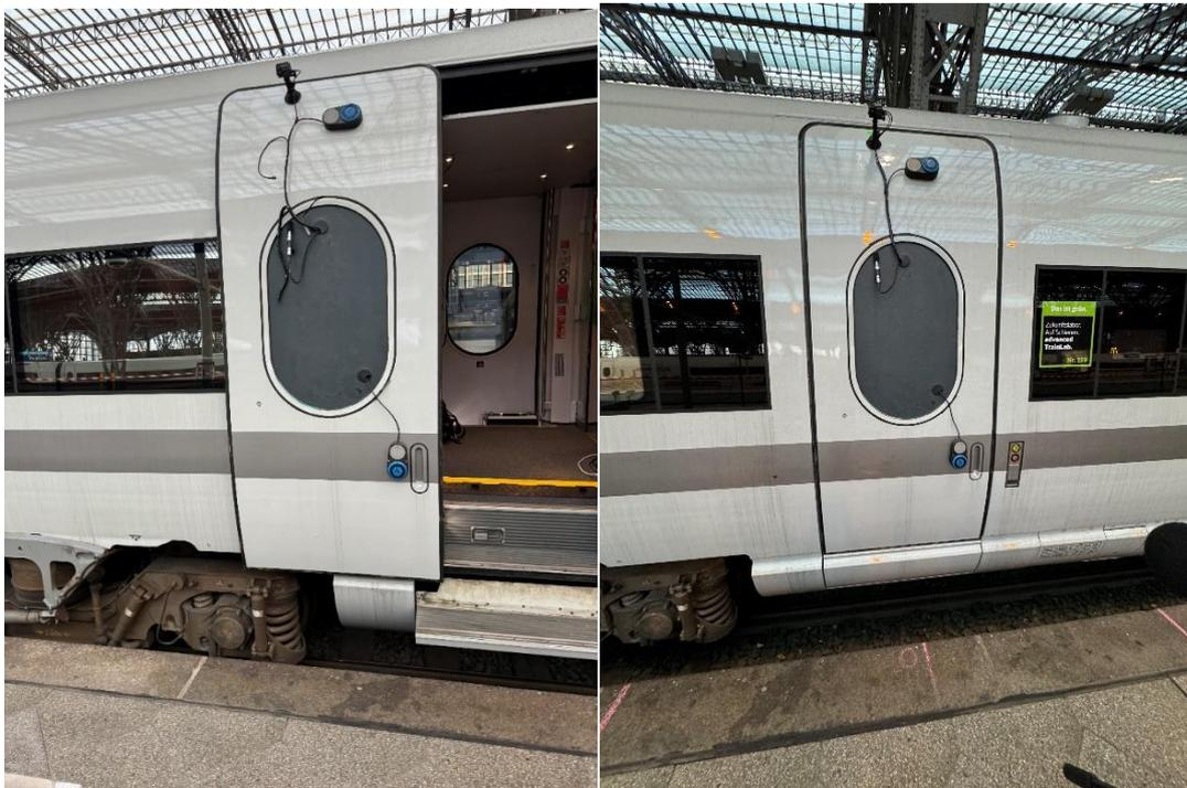
Abbildung 5.6 a-b: Ansicht der präparierten Versuchstür, (a. geöffnet, b. geschlossen)
