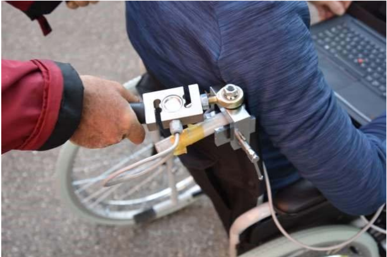
Bild 1: Der Kraftsensor wurde so an den Handgriff des Rollstuhls montiert, dass eine Drehung möglich war und somit die Druckkraft auch in einem Winkel zur Längsachse des Rollstuhls aufgebracht werden konnte.
