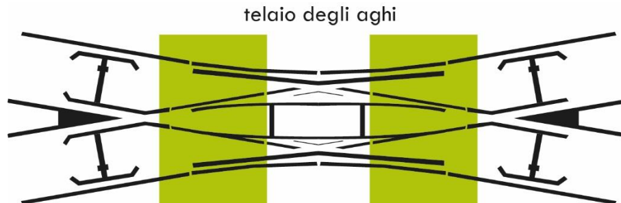
Figura B 3: telaio degli aghi in un incrocio
