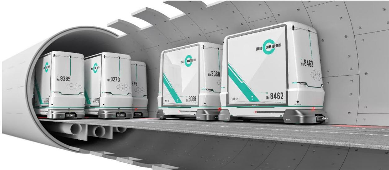
Abbildung 3-3: Visualisierung von CST Fahrzeugen im Logistiktunnel mit Raum für Leitungen unterhalb der Fahrbahn
