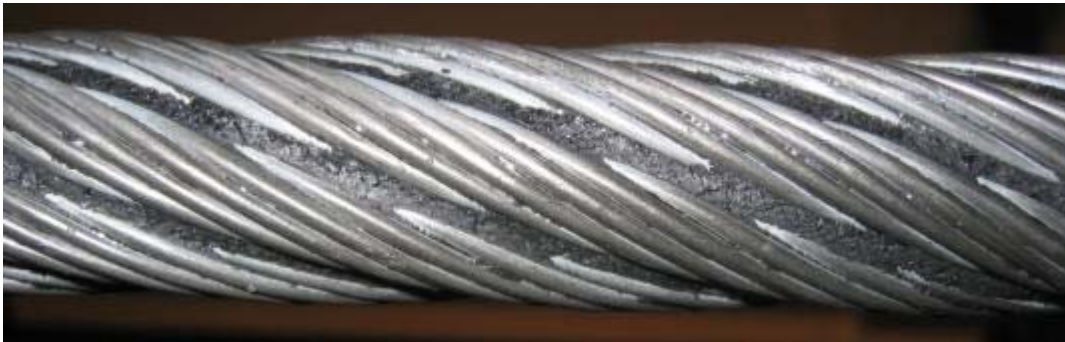
Illustration 12: Salissures dans les interstices inter-torons – inspection difficile
