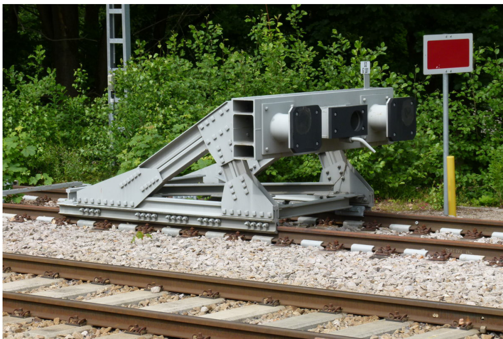
Figure 6 : heurtreur moderne (source: Bahnbilder.de)
