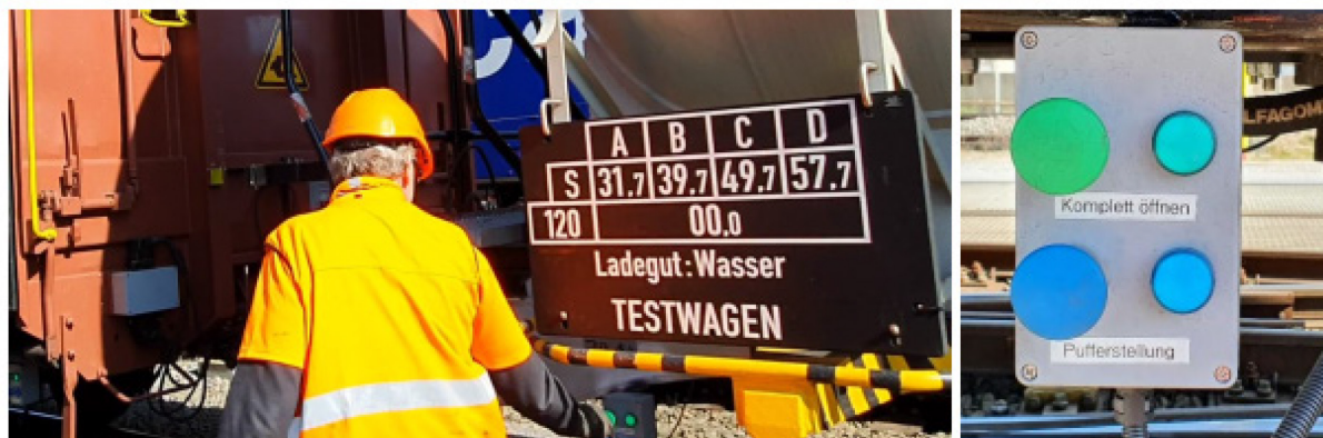
Figure 3 : dételage par simple pression sur un bouton (source : CFF Infrastructure)
