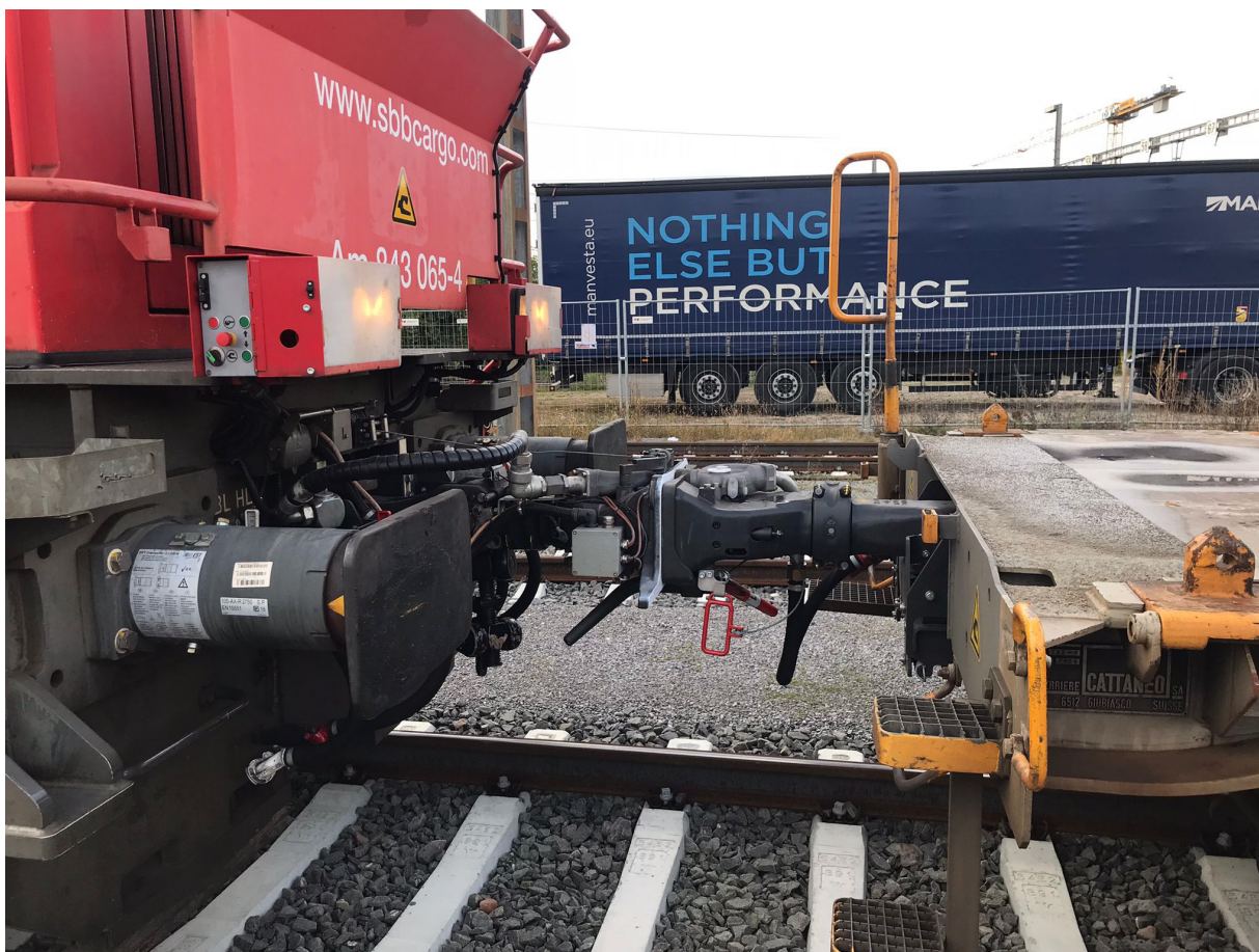
Figure 2 : grâce au DAC, le groupe de trains est attelée en un « clac » à la locomotive.
