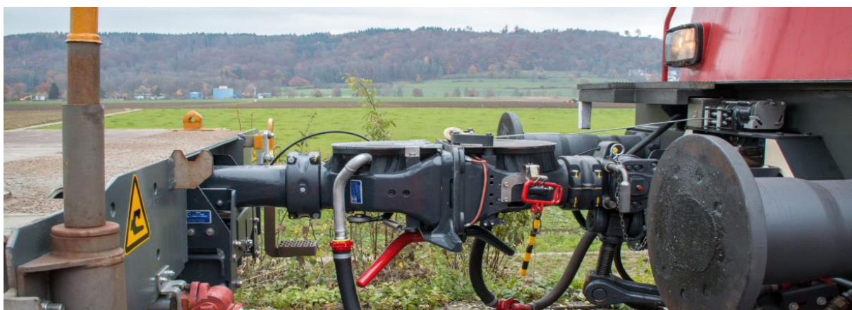
Figure 9 : attelage Scharfenberg avec conduite de frein intégrée (source : CFF Cargo)
