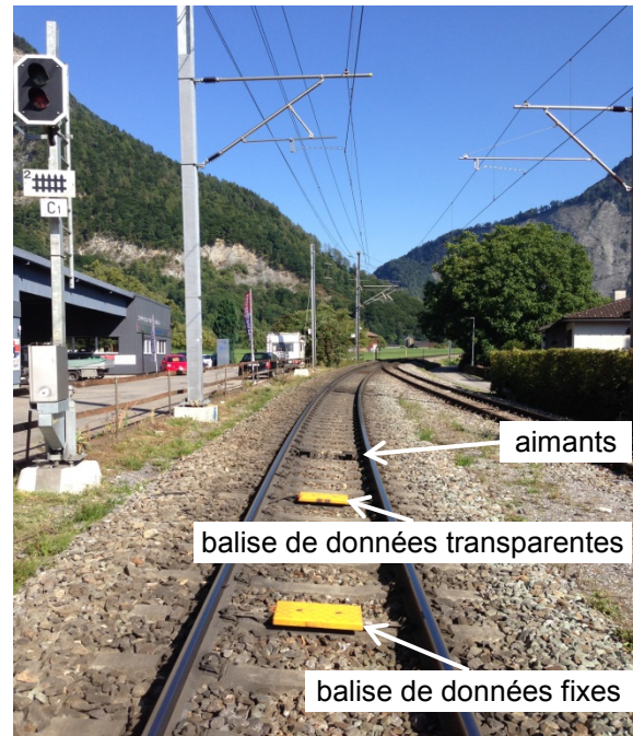
Figure 2: Installation en maintenant les aimants en service
