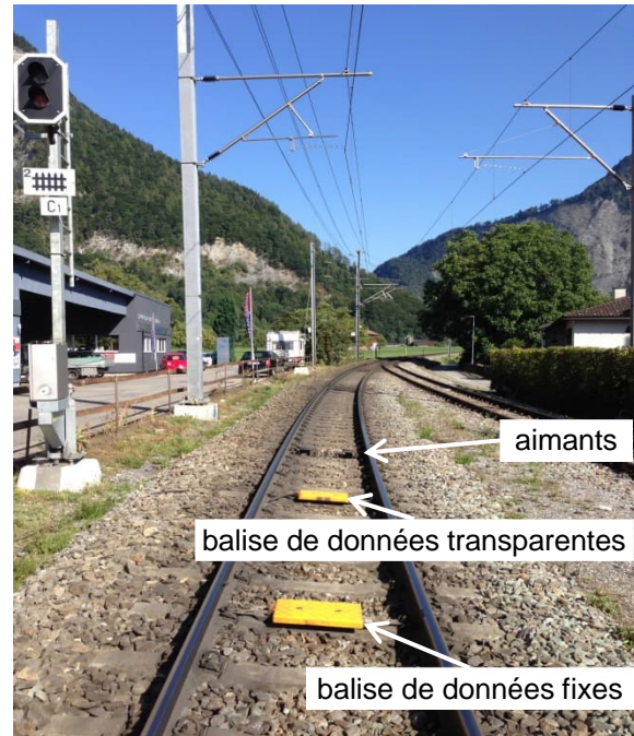
Figure 2: Installation en maintenant les aimants en service
