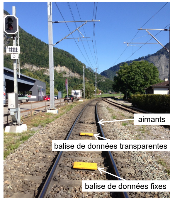
Figure 2: Installation en maintenant les aimants en service
