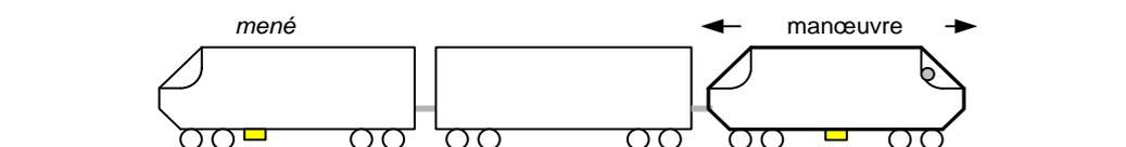
Fig. 7 Exemple de véhicule moteur en mode d'exploitation «manœuvre»
