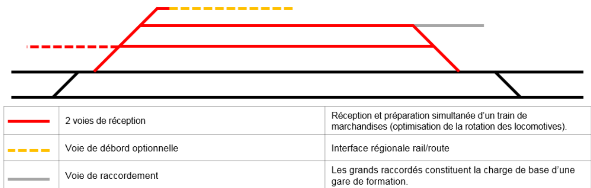
Figure 1 : structure idéale d'une gare de réception majeure
