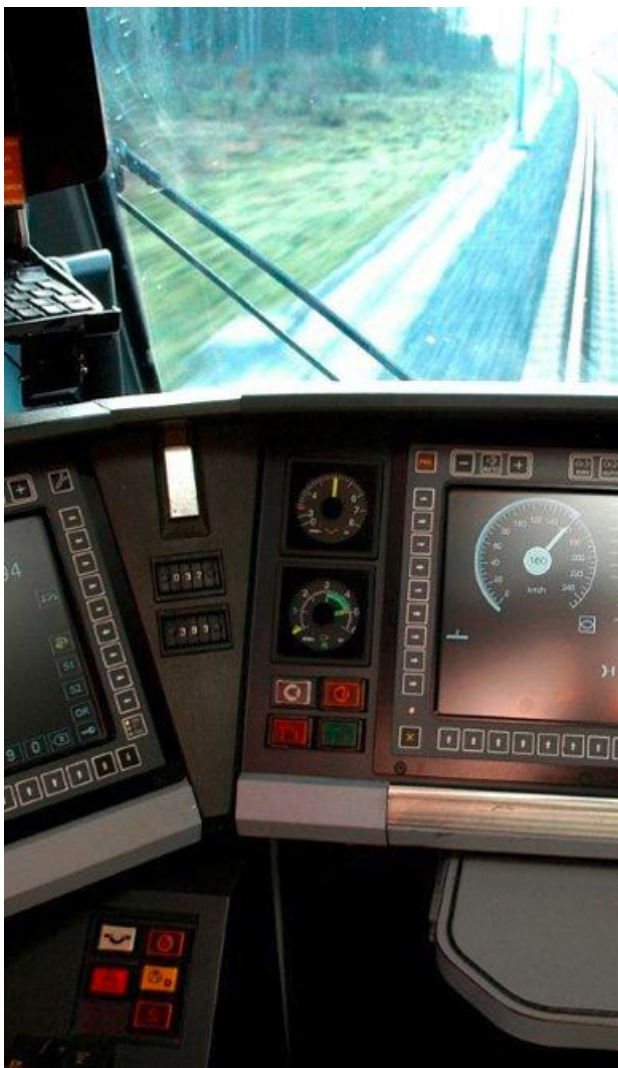
L'ETCS L2 fournit au mécanicien de locomotive les instructions sur un écran.
