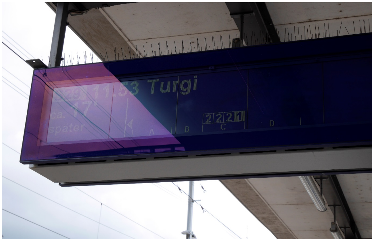
Figure 12 : Réflexions réduisant le contraste d'affichage en extérieur. Il est manifeste que les réflexions peuvent empêcher presque complètement la lisibilité. Un ciel nuageux peut avoir une plus haute luminance qu'un ciel dégagé.
