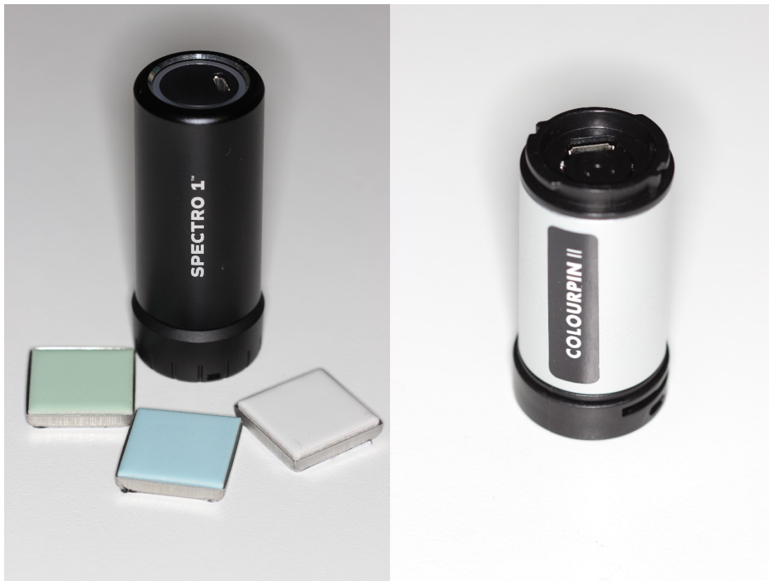
Figure 10 : à gauche : Spectro 1 avec les trois carreaux étalon, à droite : Colourpin II doté d'un étalon de réflexion pour la calibration.
