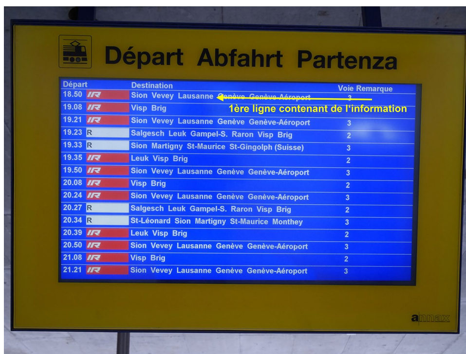
Figure 15 : La première ligne d'information est considérée comme point de repère pour la hauteur d'un tableau d'affichage (flèche jaune).
