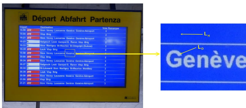
Figure 1 : Explication de la formule de contraste. La photo de gauche représente un écran comme on en trouve souvent dans les gares. L'agrandissement à droite indique à quoi se rapportent les luminances L_O de l'objet (caractères) et L_H de l'arrière-plan. Dans cette situation, le contraste selon Michelson est positif, car des lettres claires se lisent sur fond sombre.
