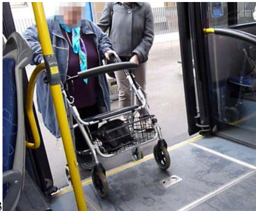
Abbildung 25: Die Probandin hebt die vorderen Räder des Rollators in den Bus und schiebt die hinteren Räder bzw. den Rollator hinterher. Anschliessend steigt die Probandin ein, diese muss sich jedoch zusätzlich an den Haltstangen im Bus festhalten.
