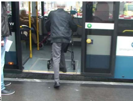
Abbildung 26: Der Proband lupft den gesamten Rollator (alle vier Räder gleichzeitig) mit Schwung in den Bus und steigt danach ein.
