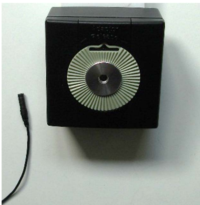
5.4 Das Mikrofon i436 mit dem eingesetzten Adapter für den Kalibrator der Firma B+K
