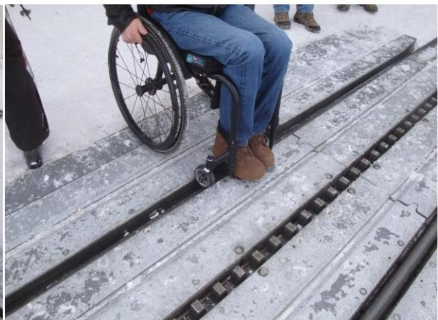
Abbildung 16: Test auf "Festfahren" resp. auf "Steckenbleiben"
