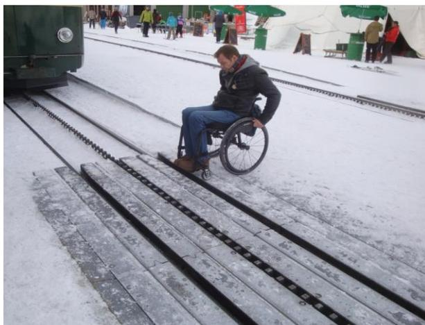
Abbildung 15: Test auf "Festfahren" resp. auf "Steckenbleiben"
