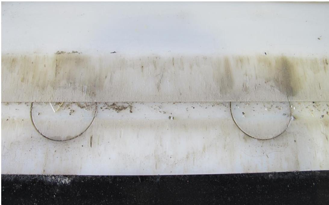
Abbildung 27: Kratzspuren an Gleitflächen
