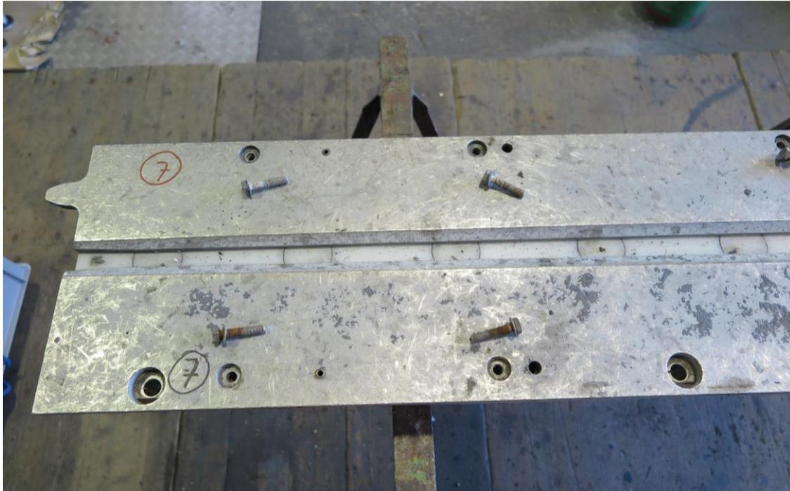
*Abbildung 28: Rost an feuerverzinkten Schrauben*
