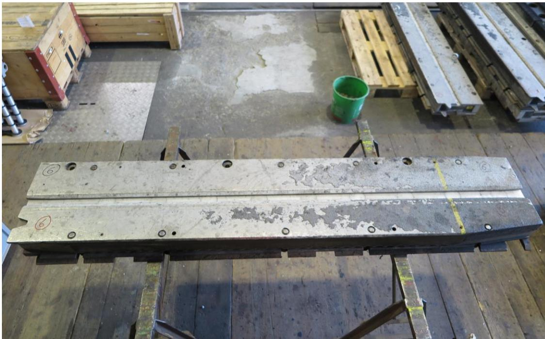
*Abbildung 29: helle Fläche => Antirutschbelag abgetragen*
