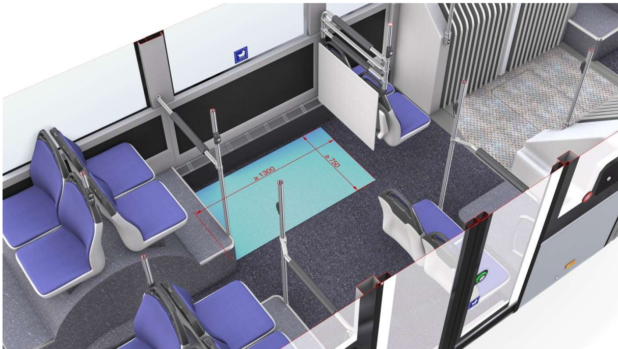
Figure 17 : place (cotée) pour poussette (vue dans le sens de la marche)
