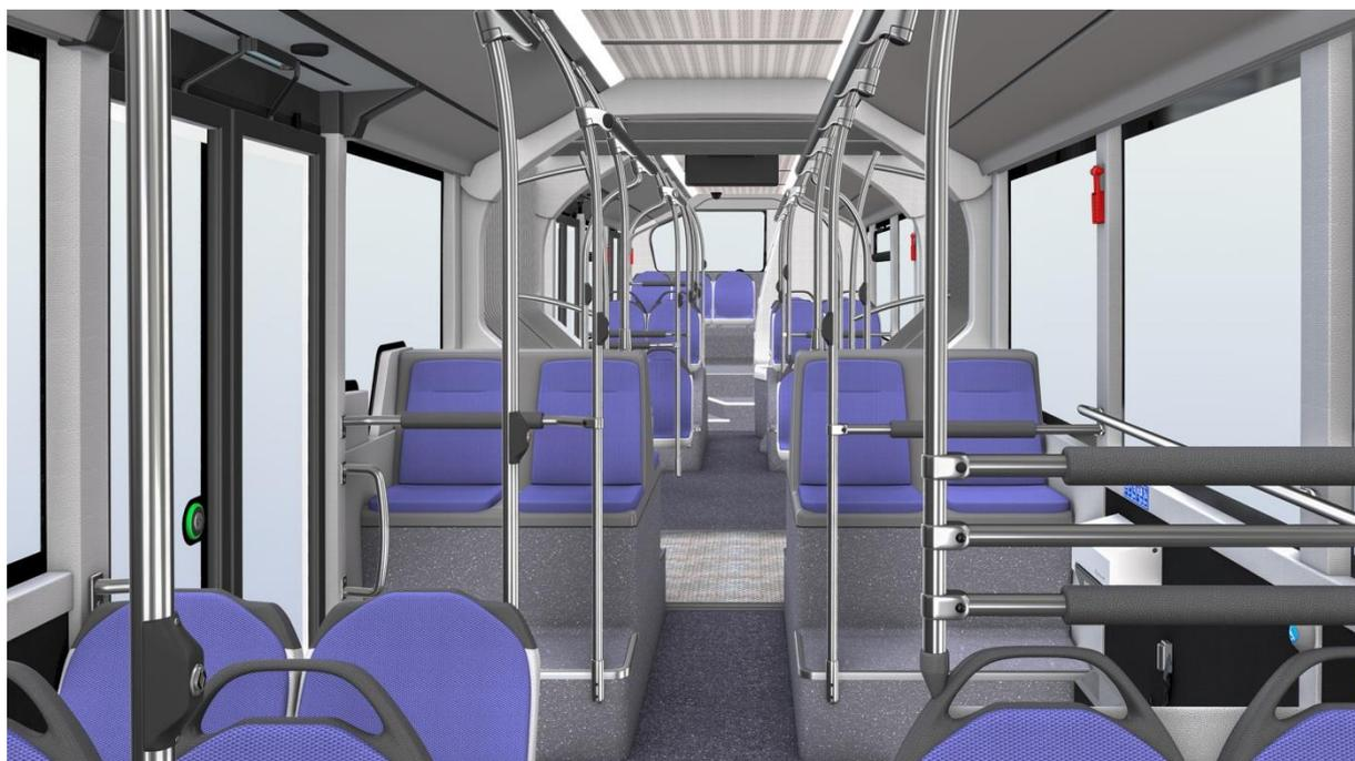
Figure 3 : Exemple de disposition des barres de maintien
