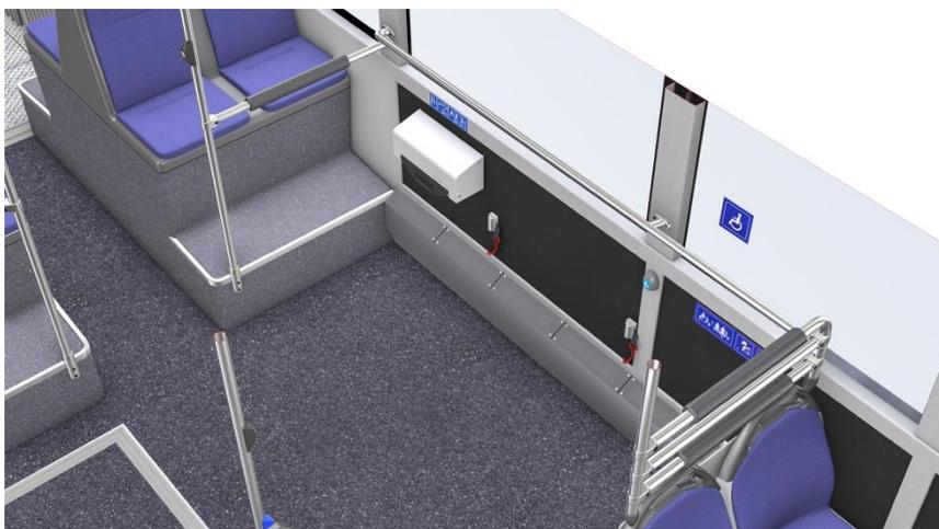
Figure 14 : Rollator-Rest / unité de sécurité sans déambulateur
