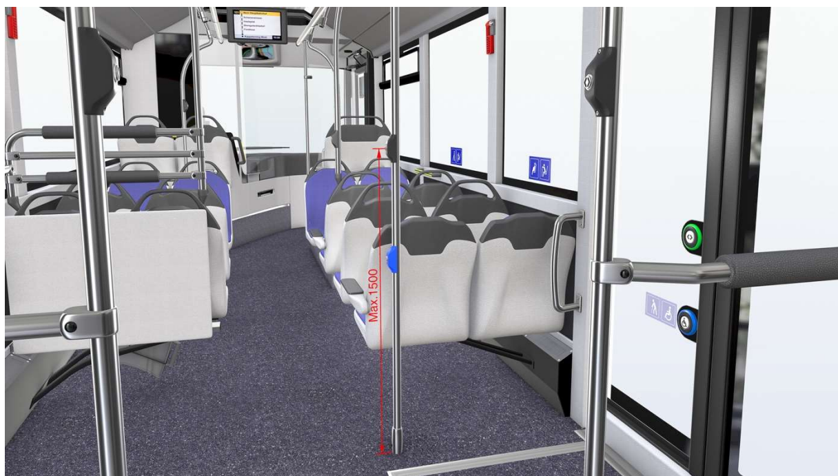
Figure 2 : Bouton-poussoir d'ouverture de porte (coté)
