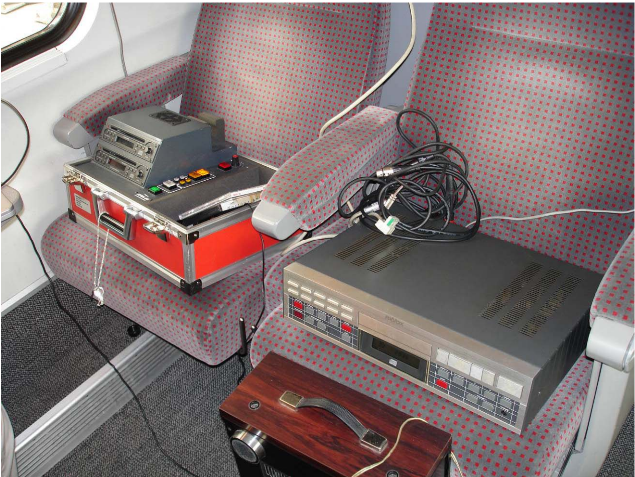
Linker Sitz: Musikeinspielkoffer der SBB, rechter Sitz: CD-Spieler „Revox“ und Leistungsverstärker zur Einspielung der Maskierungsgeräusche
