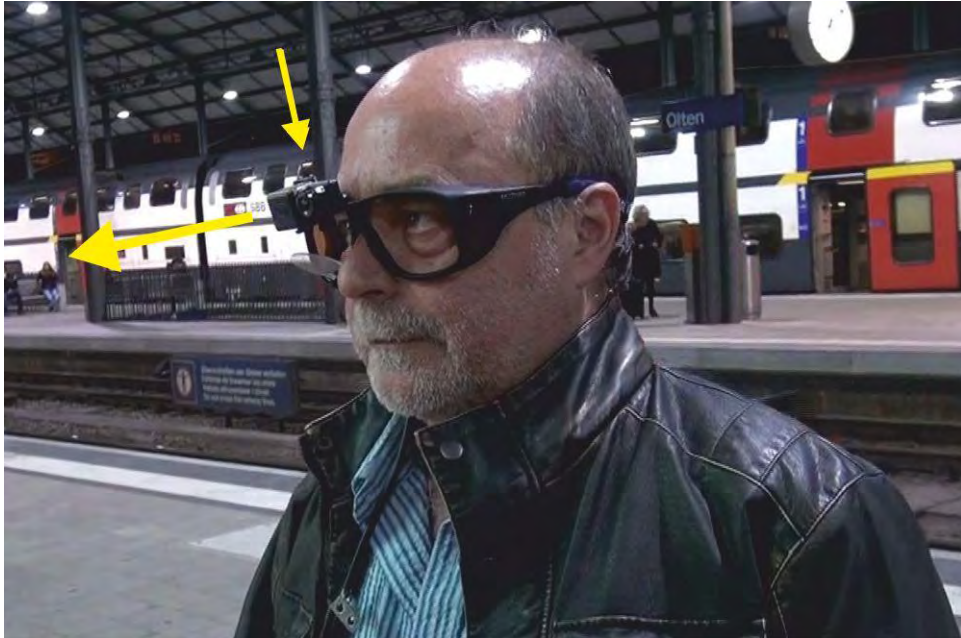
Abbildung 25: Der für die aktuelle Untersuchung eingesetzte Eye-Tracker. Mit den gelben Pfeilen werden die Kameras und die vermutete Blickrichtung angedeutet. Bildquelle: Buser 2011 .
