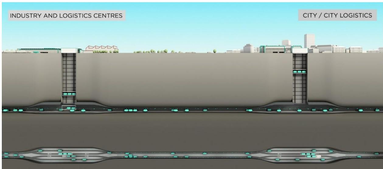
Abbildung 3-5: Visualisierung des CST Tunnels mit der Anbindung der Hubs durch vertikale Schächte und Aufsicht auf Tunnelniveau (unten)
