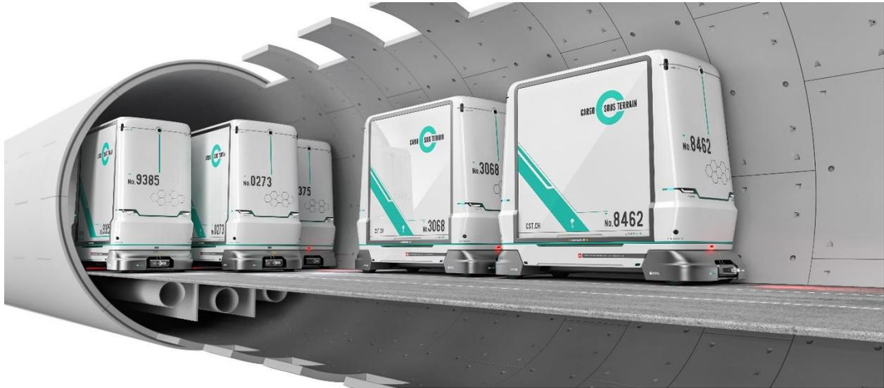
Abbildung 3-3: Visualisierung von CST Fahrzeugen im Logistiktunnel mit Raum für Leitungen unterhalb der Fahrbahn
