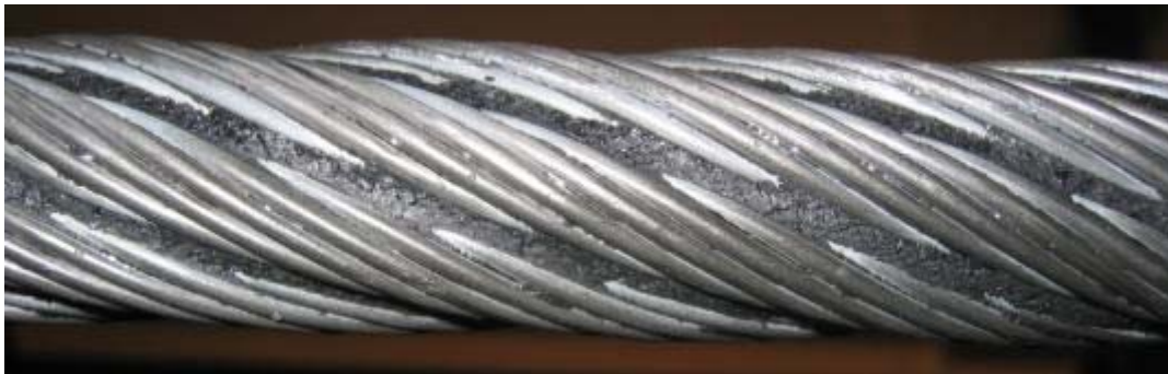
Abbildung 12: Schmutz in Litzengassen – schwer zu inspizieren
