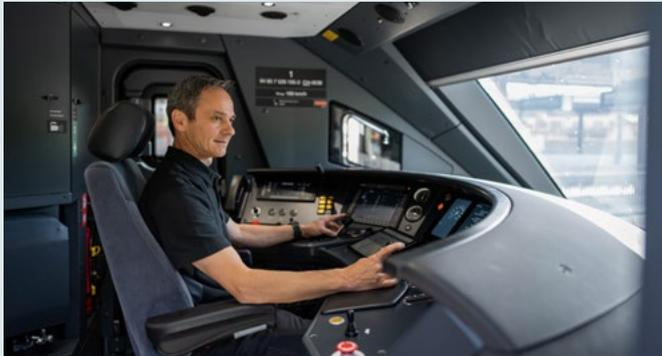
Vor der ersten Fahrt des Tages muss das Lokpersonal das Triebfahrzeug in Betrieb nehmen. Dieses sogenannte Aufrüsten dauert in Einfachtraktion 20 bis 25 Minuten. Könnte der Vorgang automatisiert werden, liesse sich wertvolle Einsatzzeit sparen, ebenso beim Abrüsten am Ende des Tages.
