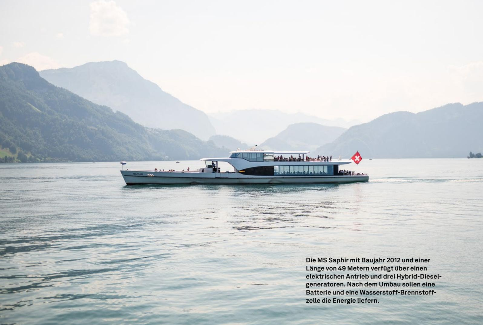
**Die MS Saphir mit Baujahr 2012 und einer Länge von 49 Metern verfügt über einen elektrischen Antrieb und drei Hybrid-Dieselelektrogeneratoren. Nach dem Umbau sollen eine Batterie und eine Wasserstoff-Brennstoffzelle die Energie liefern.**
