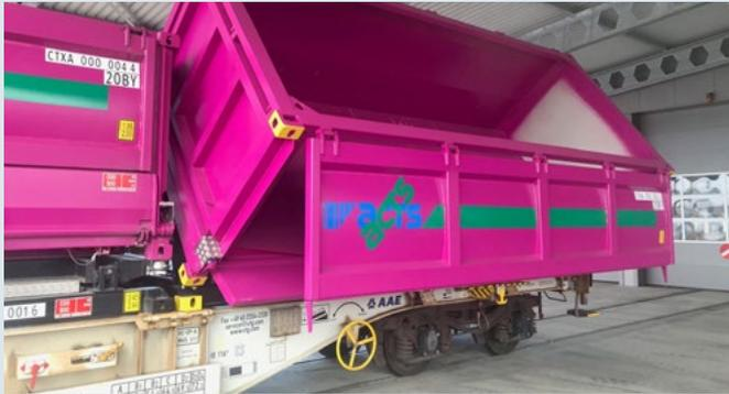
Viele Grossbaustellen können nicht direkt mit der Bahn erschlossen werden. Der Aushub bzw. Ausbruch muss dann per Lkw zum nächsten Bahnanschluss transportiert und dort auf Güterwagen umgeladen werden. Dieser zeitraubende Vorgang kann nun mit einem Kippcontainer vereinfacht werden.
