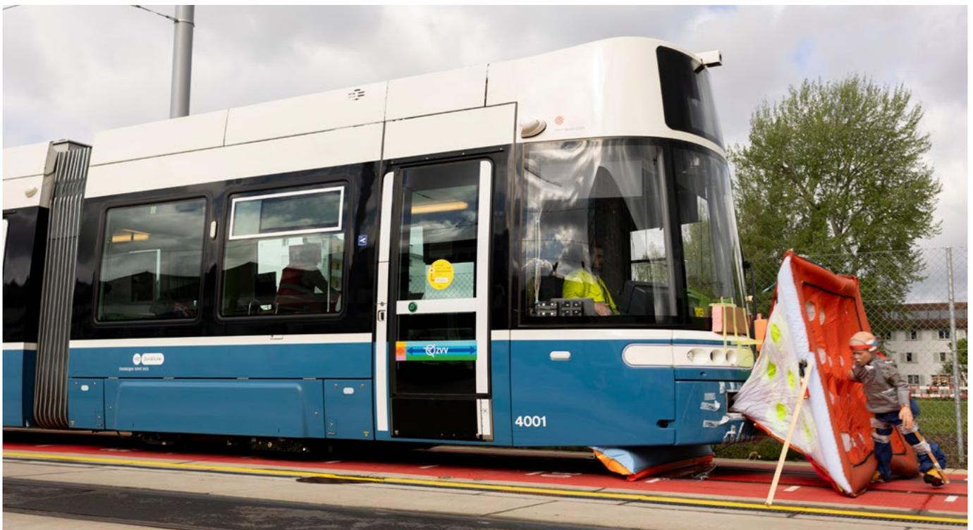
**Versuch zur Auslösung des Front-Airbags. Ebenfalls sichtbar ist ein zweiter Airbag unter dem Tram, der dem Schutz vor Überrollen dient.**
