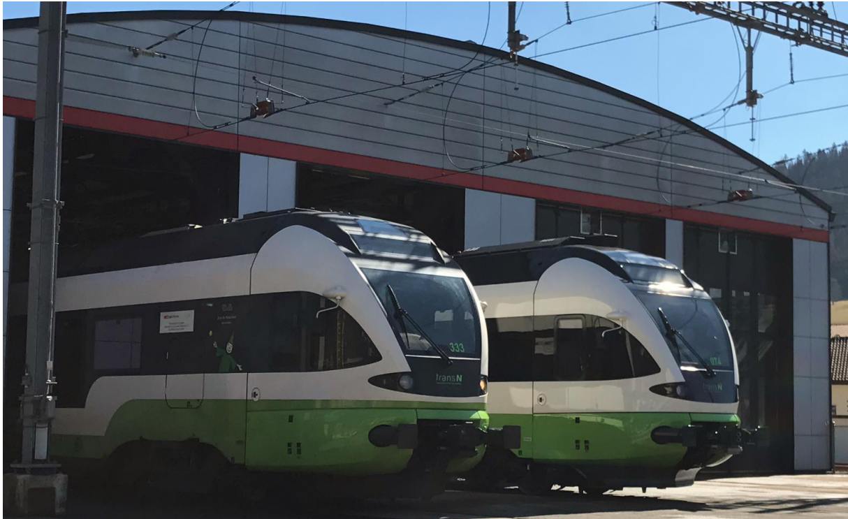
Abbildung 3: Die FLIRT 527 333 (mit ölgekühlten Transformatoren) und 523 074 (mit Trocken- transformatoren) der transN. Man beachte die unterschiedliche Dachverkleidung der beiden Fahrzeuge.
