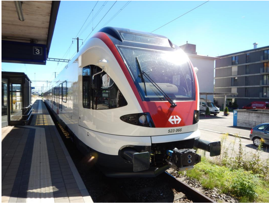
Abbildung 2: Das Prototypenfahrzeug RABe 523 066 mit Trockentransformatoren während der Störstrommessungen.
