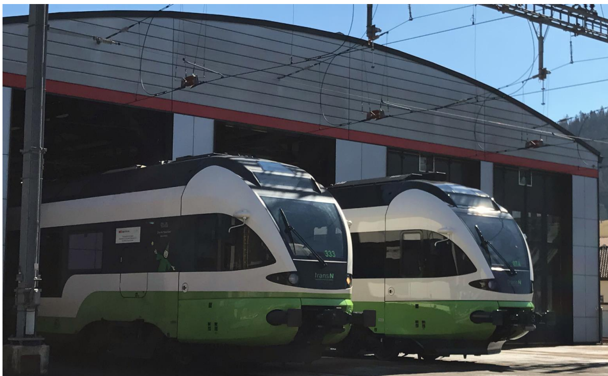
Illustration 6: Le FLIRT 527 333 (avec transformateurs refroidis à l'huile) et le FLIRT 523 074 (avec transformateurs secs) de transN. On note la différence au niveau de la toiture entre les deux véhicules.
