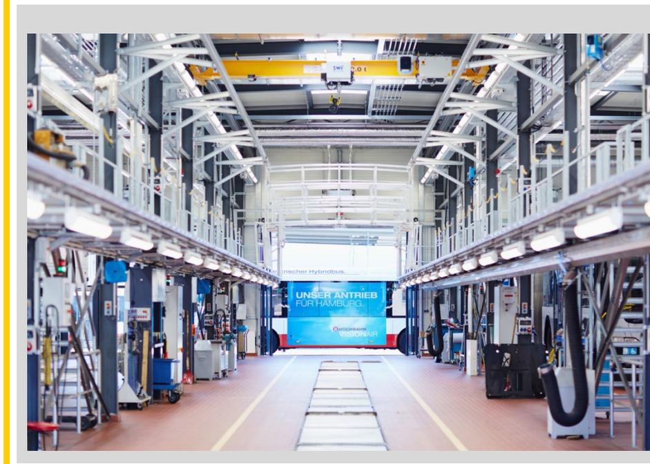
Abbildung 5.1: Dacharbeitsstand bei der FFG in Hamburg<sup>4</sup>
