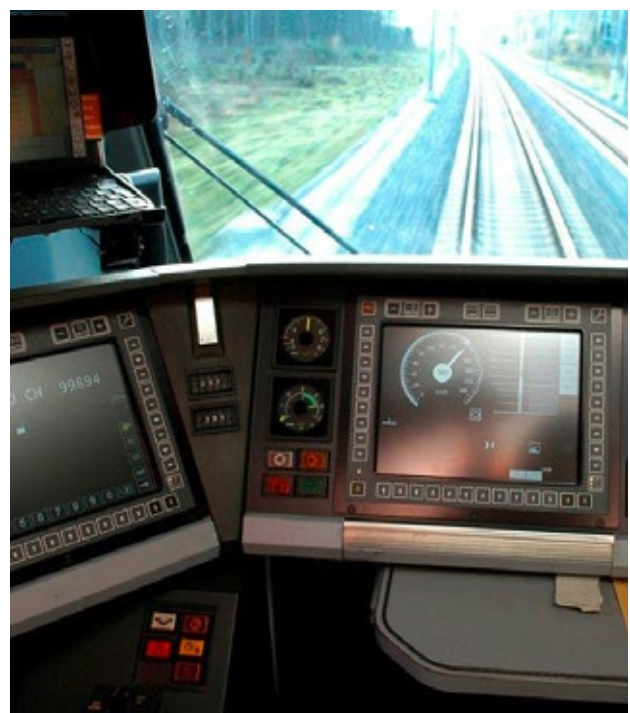
ETCS L2 liefert dem Lokomotivführer Anweisungen auf einen Bildschirm.
