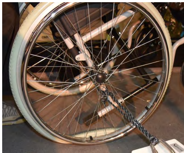
Bild 6: Beim seitlichen Zugversuch löste sich der Reifen bisweilen von der Felge.
