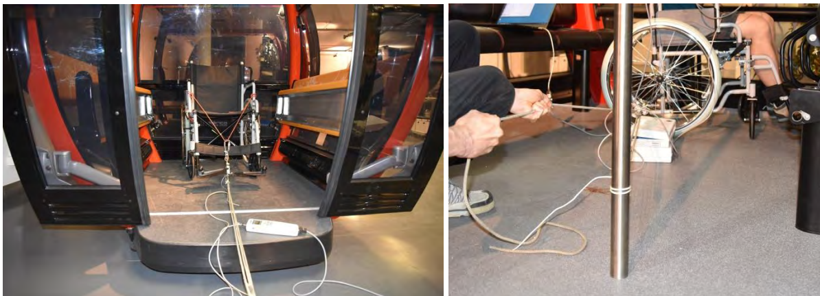
Bild 5: links: Befestigung des Zugseils für Zug vorwärts, rechts: Befestigung des Zugseils für Zug seitwärts.
