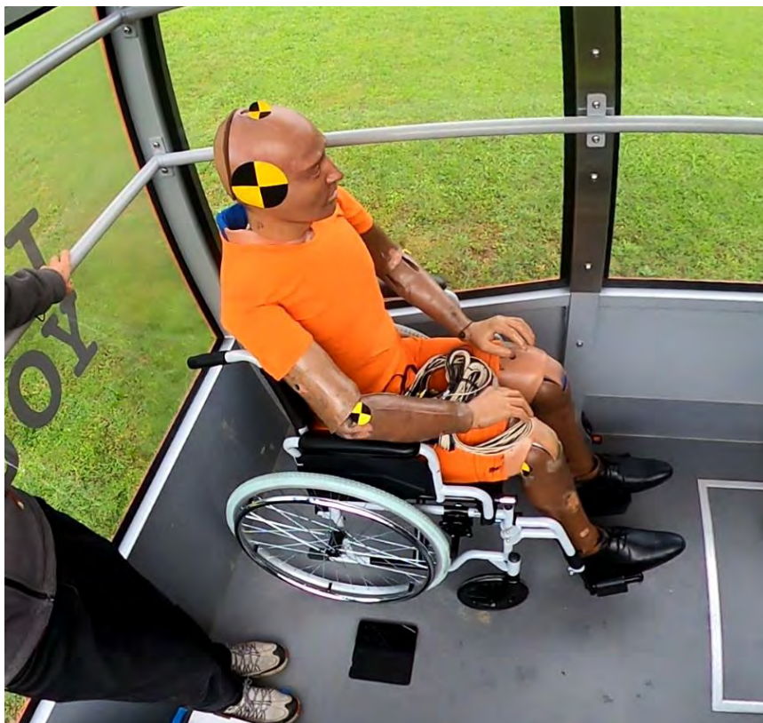
Bild 11: Versuchsaufbau in der Felseneggbahn. Der Rollstuhl ist mit den Hinterrädern in Richtung einer Anschlagfläche in einem Abstand von ca. 10 cm zu den Hinterrädern platziert. Der Rücken zeigt dabei bergaufwärts.
