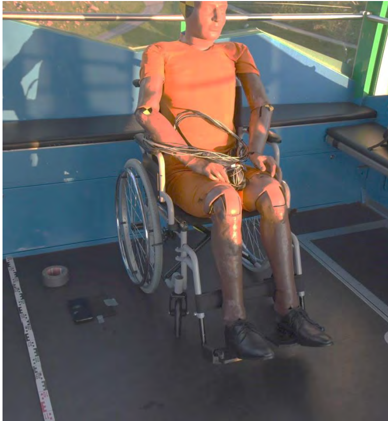
Bild 10: Versuchsaufbau in der Sämtisbahn. Der Rollstuhl ist mit den Hinterrädern in Richtung einer Anschlagfläche in einem Abstand von ca. 10 cm zu den Hinterrädern platziert. Der Rücken zeigt dabei bergaufwärts.
