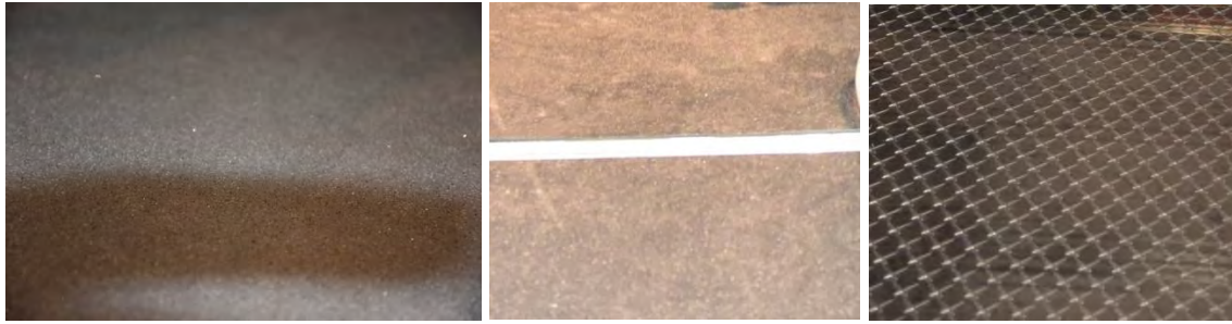
Bild 4: links: eher rauher Bodenbelag (Alto Stronghold™ 30), Mitte: eher glatter Bodenbelag (Alto Walkway™ 20, rechts: Riffelblech.
