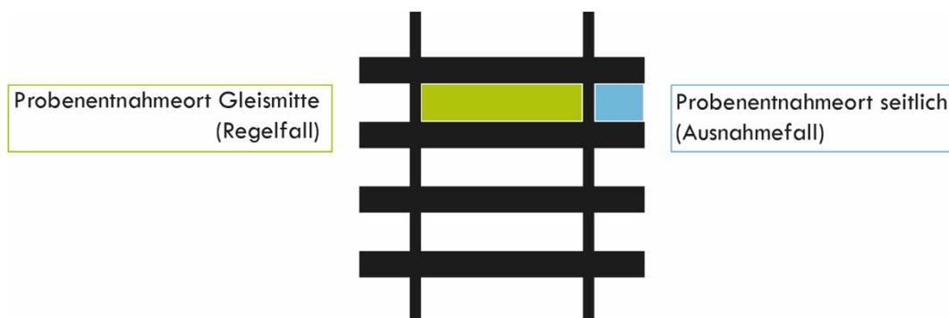
Abbildung B 1: Probenentnahmeorte, Regel- und Ausnahmefall
