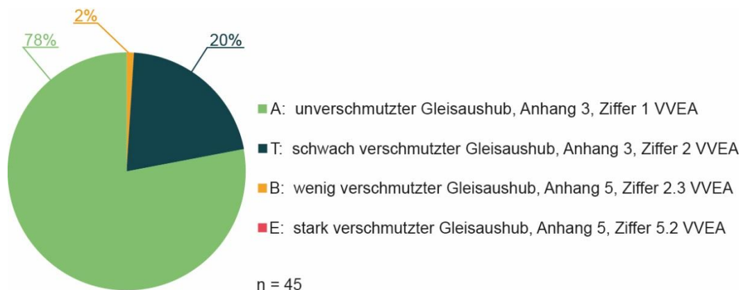
Abbildung 6: Schadstoffbelastungen des Grobschotters nach der Schotterreinigung
