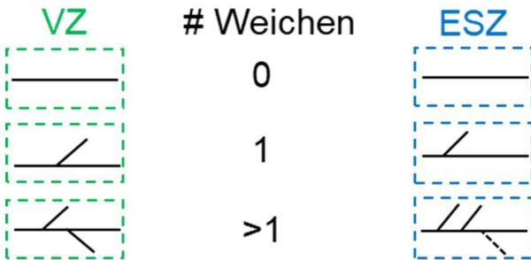
Abbildung 4-3: Bestimmung der Weichendichte durch Anzahl befahrener Weichen pro Fahrtrichtung innerhalb der VZ und der ESZ
