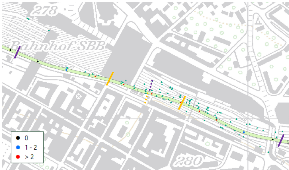
Abbildung 9: Standorte von Weichen (grüne Dreiecke), Korridor von 10 m Breite (hellgrünes Band) und resultierende Weichendichte (vgl. Punkte und zugehörige Legende) für den Abstandsbereich von 2*150 m, dessen Länge ausgehend vom Subelement in Bildmitte durch die orangen Striche dargestellt wird, am Beispiel des Bahnhofs Basel SBB. Die Grenzen des Korridors mit der Länge 2*500 m sind für dasselbe Sub-element mit violetten Strichen versehen. Für dieses resultiert für beide Korridorlängen eine Weichendichte von > 2.
